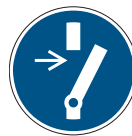
M021: Vor Arbeiten freischalten
